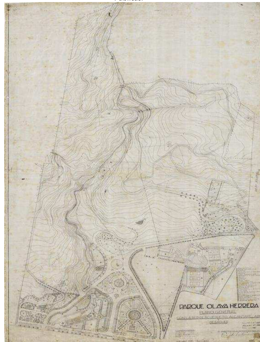
Imagen 13. Plano general del Parque Nacional Olaya Herrera. Red de acueducto, alcantarillado y desagües. 1940 aprox. Ministerio de Obras Públicas.
