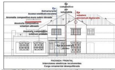
Figura 37. Análisis de la fachada principal: relación anomalías y carga formal. Fuente: elaboración propia sobre plano levantado en 2025.
