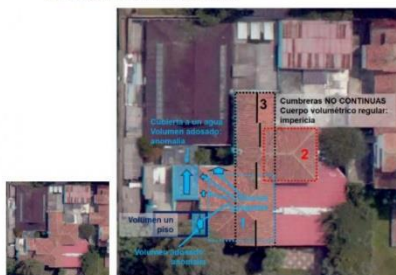
Figura 31. Análisis de las anomalías de cubiertas y volúmenes Fuente: elaboración propia con base en Google Maps.
