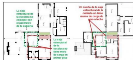
Figura 32. (Izq.) primer piso, (der.) segundo piso. Planos 2025 (muros demolidos) Lo que se quiere mostrar es el deber ser geométrico-estructural, 23 pero otra cosa pasó en las obras. Fuente: elaboración propia sobre planos levantados en 2025.
