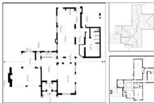
Figura 40. Planos primarios, segundo piso y cubiertas. Ubicación de la grieta. Se muestra la grieta principal, dado que la grieta fue reparada con mortero y los cubiertas, están completas. Fuente: elaboración propia con base en levantamiento de marzo de 2025.
