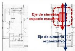
Figura 31. Detalle de la zona acceso-vestibulo-escala que muestra desfases simétricos Fuente: elaboración propia.
