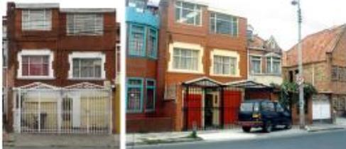
KR 16 48 59 En la aerofotografía de 1998 se observa que se ha construido una tercera planta cubierta con teja de fibrocemento, además se ha edificado todo el predio, ocupando el aislamiento y los vacíos iniciales, en la primera planta se percibe la modificación de vanos, generando dos locales comerciales, alterando su volumetría e implantación original.
