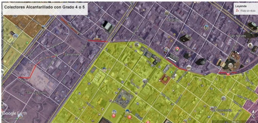
**Figura 8. Colectores con Grado 4 o 5 en su calificación estructural**
